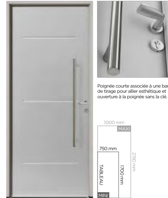
CARASSIN Ouvrant post-formé 2 faces. Poignée courte et barre de tirage extérieure*. Serrure à relevage 5 points. Ud = 1,0
