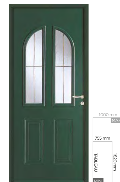
VISTALE Ouvrant et soubassement post-formés 2 faces, double vitrage feuilleté givré, petits-bois aspect laiton. Ud = 1,3
