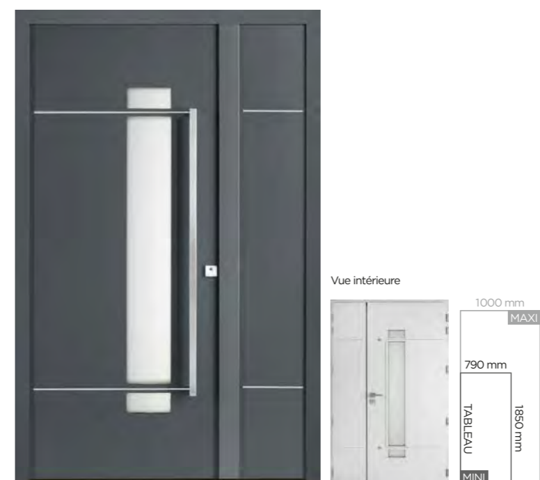
GLOSSY 80 MM AVEC SEMI-FIXE ASSOCIÉ Décors aspect inox face extérieure, rainures face intérieure, triple vitrage feuilleté sablé, barre de tirage traversante. Ud = 1,0
