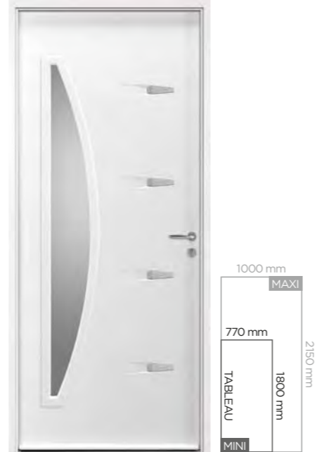
SILVER PALAOS Ouvrant post-formé 2 faces. Décor finition Silver face extérieure. Double vitrage feuilleté sablé. Ud = 1,3
