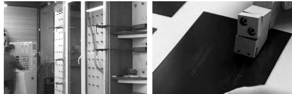
Banc d'essais A.E.V. (tests à l'air, à l'eau et au vent).
