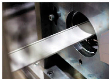
Profilage de la lame Alu Ev 45 dans nos ateliers
