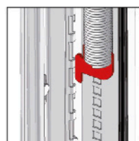
Réglage de ressort par console basse avec crans (numéro de crans notifié en bas du rail grâce à une pastille : degré de liberté = +1/-1)
