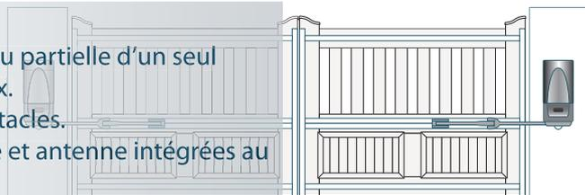
Nécessite un dégagement de 50 cm de chaque côté. Serrure électrique préconisée pour les portails de plus de 4 m.
