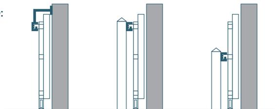
Etrier de guidage fixé sur le pilier
